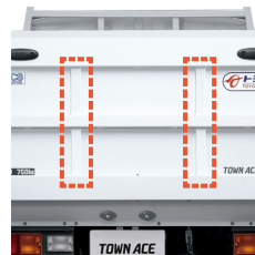
⑧ プラットホーム裏面補強
