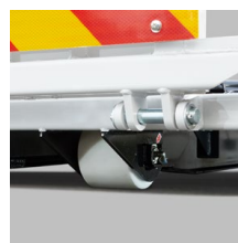
⑩ 荷台接地ローラ(樹脂製)
