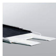
⑫ワンタッチロック式中折れリヤゲート(手動式)
