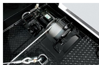
① 油圧ウインチ1.5t用 (オートクラッチ付)
