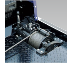
⑥ 油圧ウインチ2t用 (オートクラッチ付)
