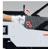
⑪ テールゲート 左右連動ロック装置
