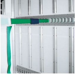
⑤④⑤⑤ ラッシンググレール&ベルト
