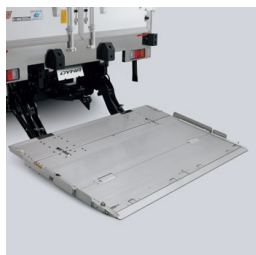
㊳ 床下格納ゲート
