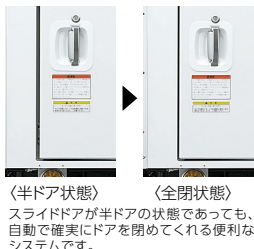
㉗ イージークローザー(左スライド式) (半ドア状態) (全閉状態) スライドドアが半ドアの状態であっても、自動で確実にドアを閉めてくれる便利なシステムです。
