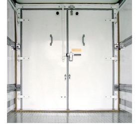
⑥② 観音扉移動式間仕切り
