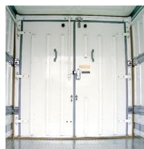
③ 観音扉移動式間仕切り
