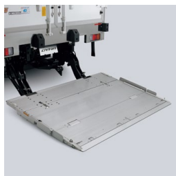
⑧② 床下格納ゲート
