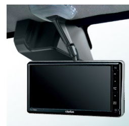
⑦④ バックモニター (インナーミラータイプ)
