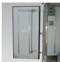
② バックドア90°開き ストッパー(1ナンパークラス)
