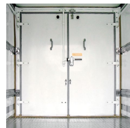
⑥② 観音扉移動式間仕切り
