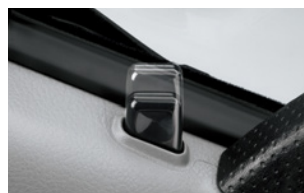
▶パワーロック(前席・後席) ※前席のパワーロックは助手席のみとなります。 ダブルキャブ車
