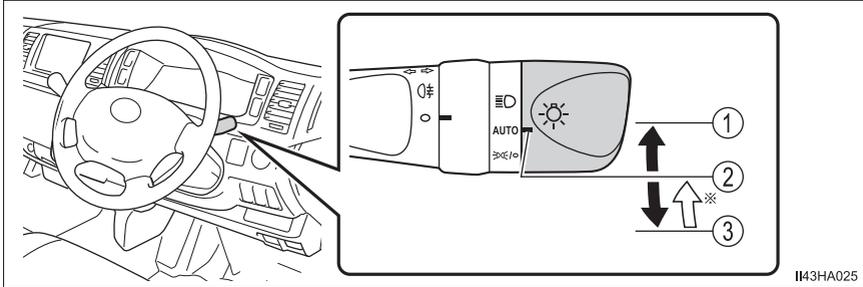
※ スイッチを③  $\text{OFF}$  の位置へ操作し手を離すと、自動的に②  $\text{AUTO}$  の位置へ戻ります。
