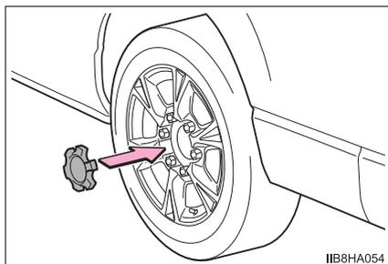
タイヤのバルブ（空気口）に切り欠きを合わせてホイールキャップを確実に取り付けます。
