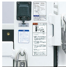
㉔ リフトスイッチ(車両左側)
