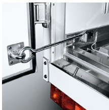
㉓ バックドア90°開き ストッパー簡易型
