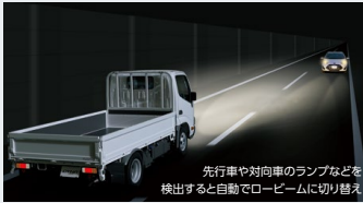
先行車や対向車のランプなどを検出すると自動でロービームに切り替える
